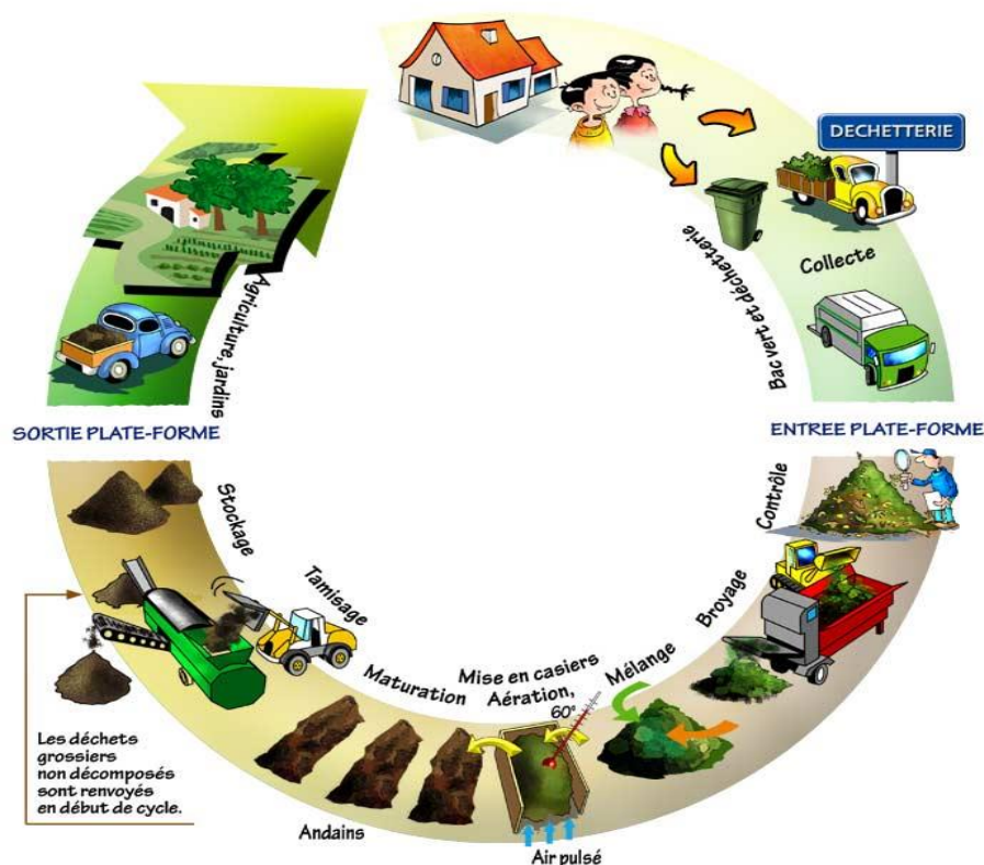
Figure 11. Schéma de principe pour la valorisation des déchets organiques par compostage
