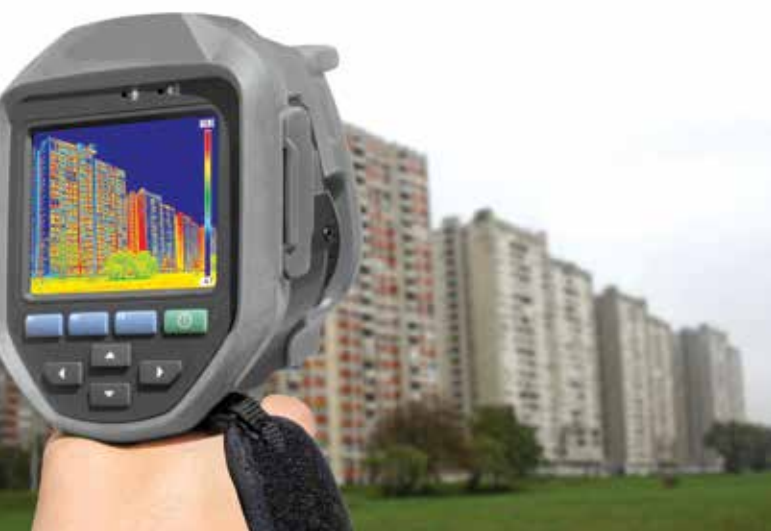
Erfassung der Wärmeverluste mit einer Wärmebildkamera
