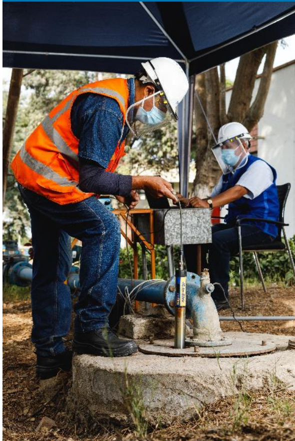
Grundwasserüberwachung mit einer Sonde im Wasserversorgungsunternehmen „Sedalib“.
