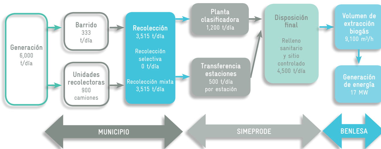
GRÁFICO D.2. Diagrama del manejo integral de residuos sólidos
