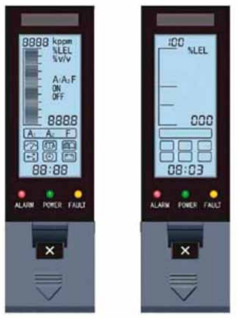
FIGURA 4.20 INDICADOR DE ATMÓSFERA EXPLOSIVA EN GASÓMETRO.
