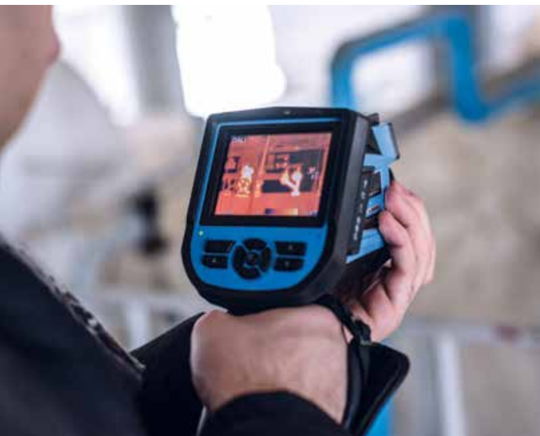
Erfassung der Wärmeverluste mit einer Wärmebildkamera
