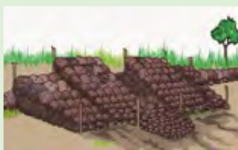
Digue construite avec déversoir
