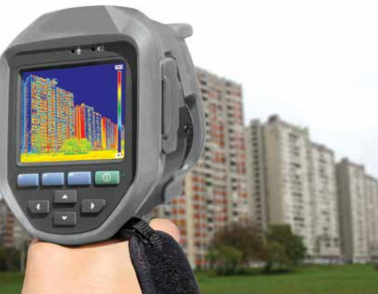
Інфрачервона камера показує втрати тепла в будинку
