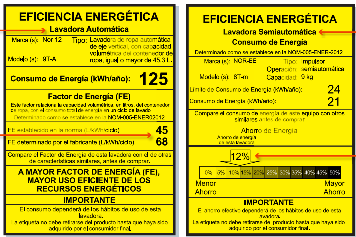
FIGURA 9 ETIQUETA DE EFICIENCIA ENERGÉTICA PARA LAVADORAS
