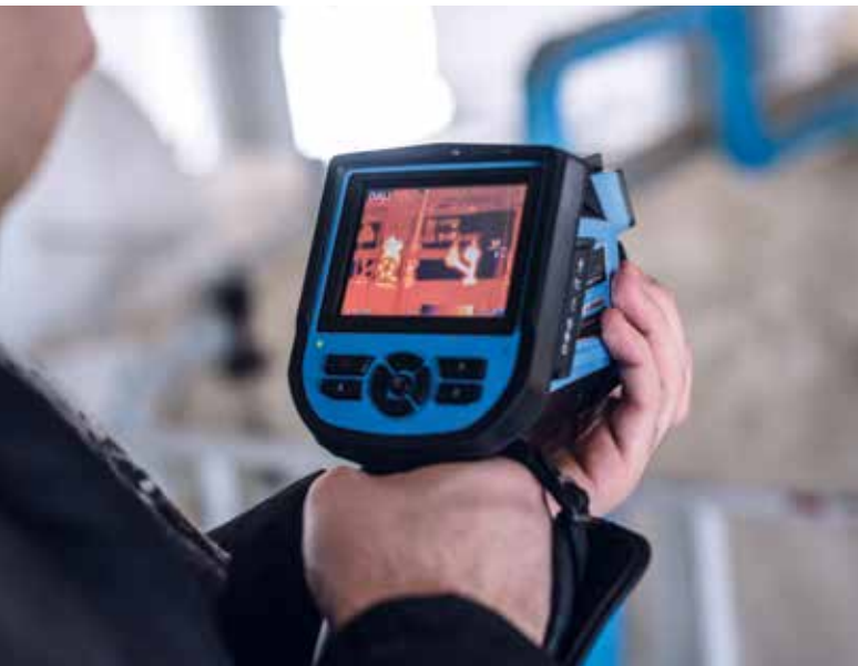
Інфрачервона камера показує втрати тепла в будинку
