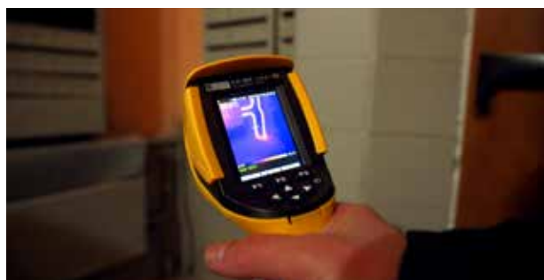
Ein Energieauditor prüft mit einer Wärmekamera die Wärmeverluste in einem Gebäude.
