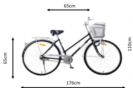
Hình 3.4. Kích thước xe đạp phổ biến (Nguồn: ©GIZ/Lê Sơn)
