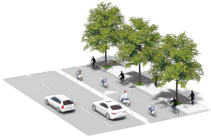
Hình 5.8. Làn đường dành cho xe máy và làn đường dành cho xe đạp được phân cách bằng vạch kẻ đường
