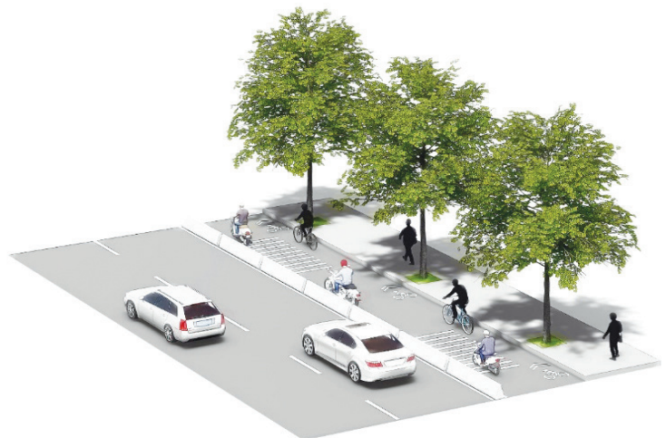
Hình 5.9. Xe máy và xe đạp đi chung làn đường, xe đạp sử dụng phần lề đường
