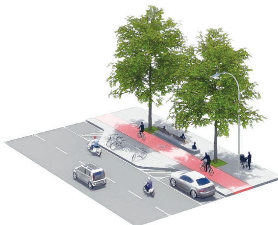
Hình 3.14. Làn xe đạp được bảo vệ bằng cách nâng cao độ đường xe đạp bằng hè phố
