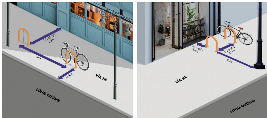
Hình 7.1. Thể hiện khoảng cách tối thiểu giữa các giá đỡ xe đạp và giữa giá đỡ xe đạp với mép đường công trình
