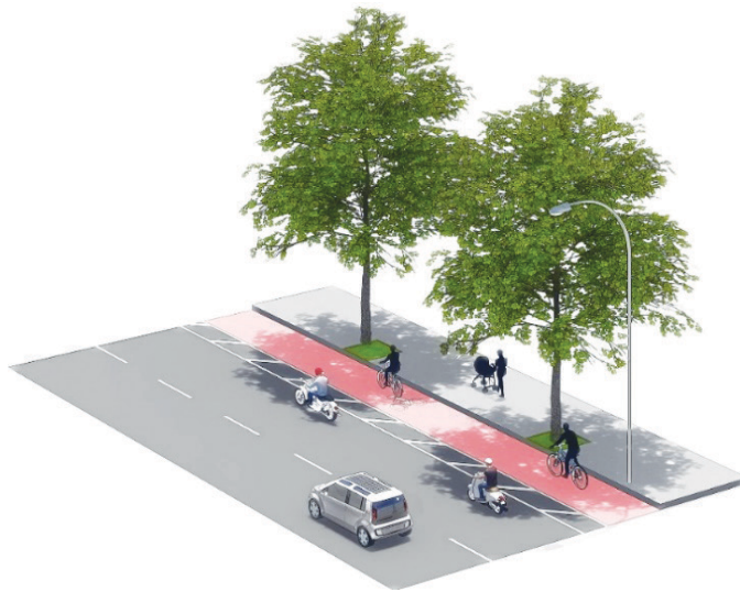
Hình 3.8. Làn dành riêng cho xe đạp sử dụng vạch sơn kênh hóa
