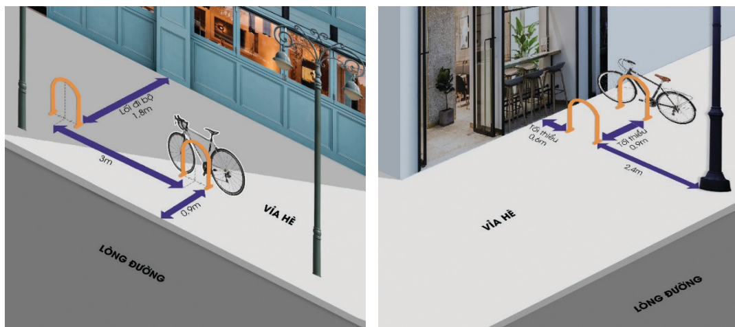
Hình 7.1. Thể hiện khoảng cách tối thiểu giữa các giá để xe đạp và giữa giá để xe đạp với mép đường công trình
