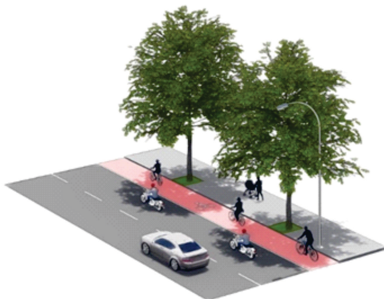
Hình 3.7. Làn xe đạp dành riêng được phân cách bằng vạch sơn liền nét
