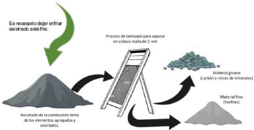
Figura 12. Tamizado y separación carbonos y cenicillas de la calcinación de huesos. Fuente. Elaboración propia
