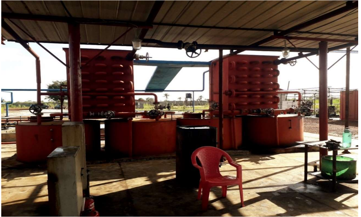
Image 24 : le système de refroidissement de la chaîne de valorisation des huiles usées de Tanènè
