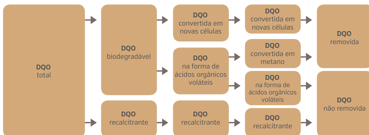
Figura 2.2: Balanço esquemático de DQO, ao longo do processo de degradação anaeróbia.
