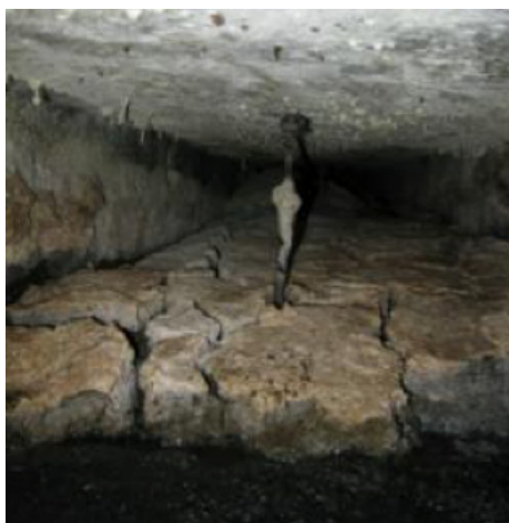
Figura 3.13: Foto do separador trifásico rompido por conta da obstrução, pela espuma, da tubulação de saída do biogás.
