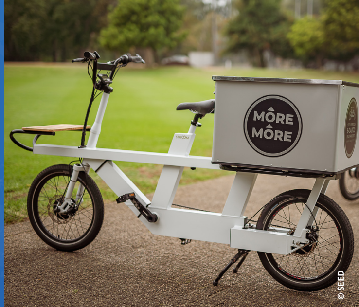
Prototyp “Long Tail” mit Transportbox auf Gepäckträger
