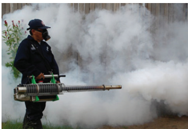
صورة (27). جهاز يدوي لتوليد الضباب
