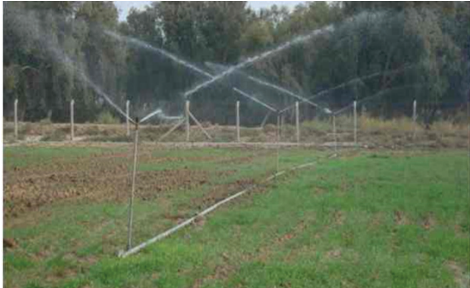
نموذج رقم ( 3 ) تشغيل نظام الري بالرش بعد تركيب الشبكة
