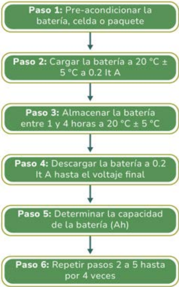
Figura 12 ▼ Procedimiento para determinar la capacidad de una batería de iones de litio. Fuente: Adaptado de ISO 12405-4:2018.
