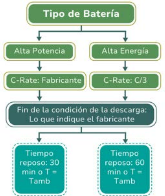
Figura 11 ▼ Ciclo estándar de carga de acuerdo con el tipo de batería. Fuente: Adaptado de ISO 12405-4:2018
