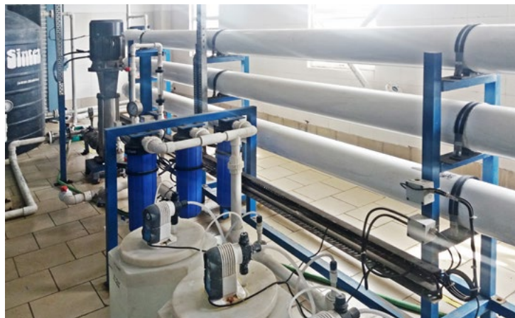
الشكل ١: (يساراً) هيكل مرحلة الغشاء باستخدام تقنية الطرح منعدم السوائل لمياه الصرف في الطلاء الجلفاني البلاستيكي (يميناً) صورة لمرحلة RO ١
