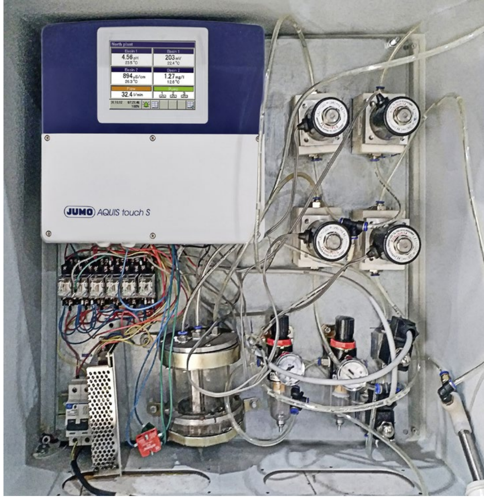
شكل ٢: جهاز قياس معياري متعدد القنوات مزود بوحدة تحكم متكاملة ومسجل غير ورقي JUMO AQUIS touch S
