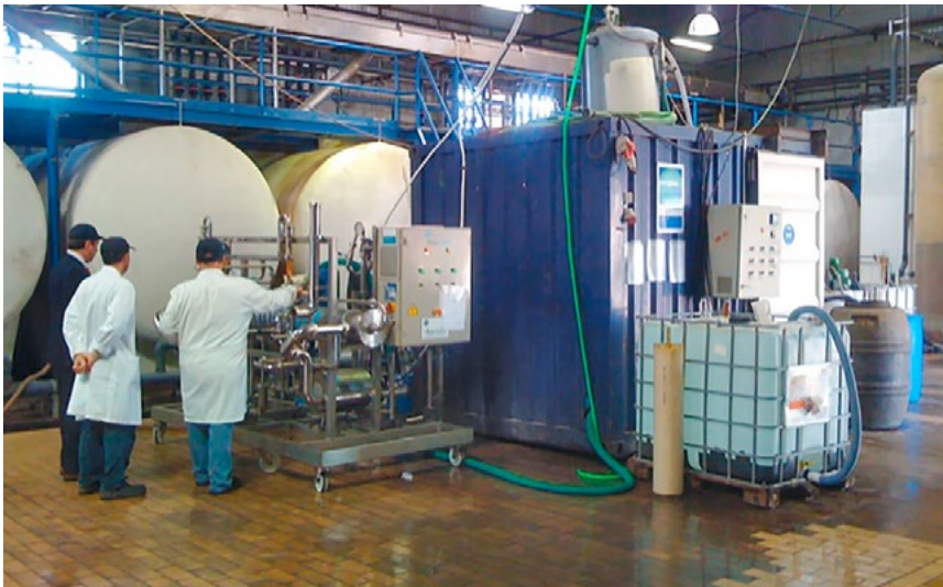
شكل ١: نظام AQUATECTOR® Microfloat® المتنقل للمعالجة الموسمية لمياه الصرف الناتجة عن معالجة الزيتون كمشاريع تجريبية في لبنان وسوريا والأردن
