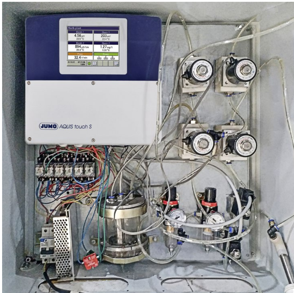
Abbildung 2: modulares Mehrkanal- messgerät mit inte- griertem Regler und Bildschirmschreiber JUMO AQUIS touch S
