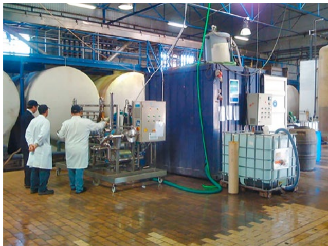
Abbildung 1: Mobile AQUATECTOR® Microfloat®-Anlage für die saisonale Behandlung von Abwässern aus der Olivenverarbeitung als Pilotprojekte im Libanon, Syrien und Jordanien
